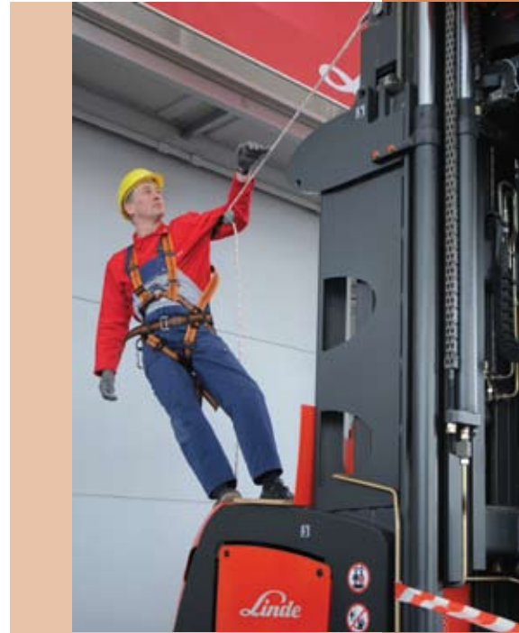
Sicherheitsfachkraft der Fa. Suffel, Siegfried Seitz, demonstriert den Arbeitsschutz für Servicemonteur bei der Reparatur von Hochregalstaplern anhand Sicherheitsgurt, Kettenhandschuhen und Schutzhelm.
